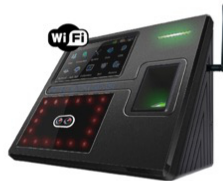
Bioface: Captura de rostro de cada empleado en el dispositivo para validar sus ingresos y salidas por reconocimiento facial
